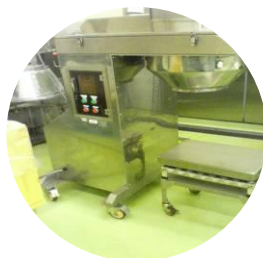
粉碎机（施工例）
